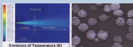
Abb. 2: Sprüh-Gefriertrocknung mit überkritischem CO<sub>2</sub> zur Herstellung von porösen Partikeln
